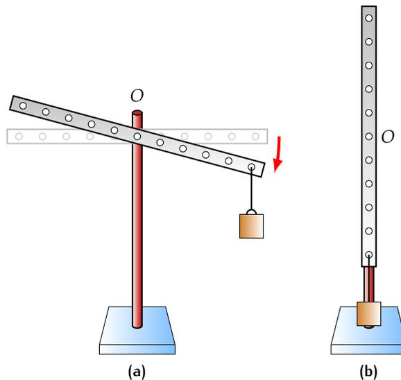
Figura 48: Un carico nel foro più esterno determina un nuovo equilibrio
