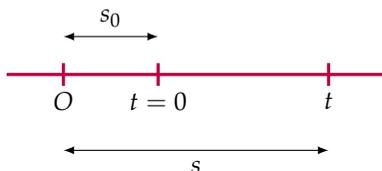
Figura 13: Spazio percorso dopo il tempo  $t$  in un moto rettilineo uniforme
