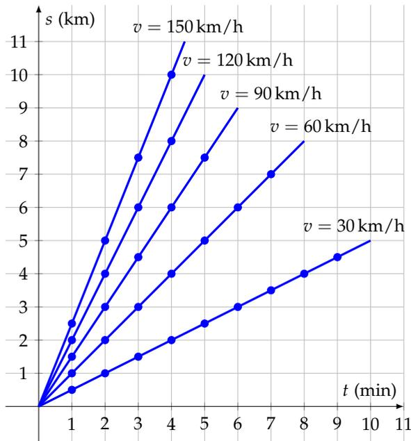
Figura 16: Diagrammi orari di auto con diverse velocità
