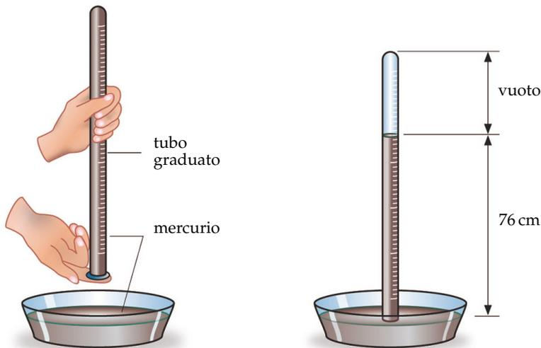
Figura 67: Esperimento di Torricelli
