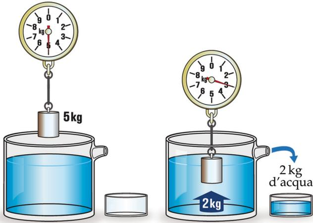
Figura 62: Principio di Archimede
