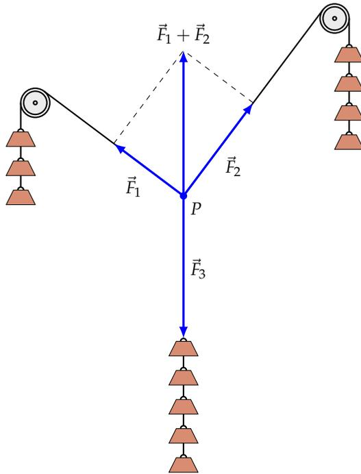
Figura 36: Il punto  $P$ , sotto l'azione delle tre forze  $\vec{F}_1$ ,  $\vec{F}_2$  e  $\vec{F}_3$ , è in equilibrio
