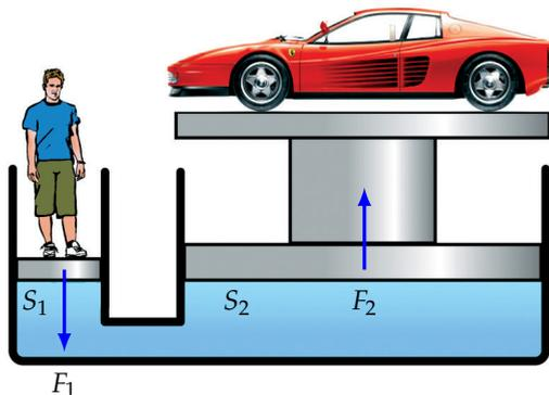
Figura 58: Sollevatore idraulico
