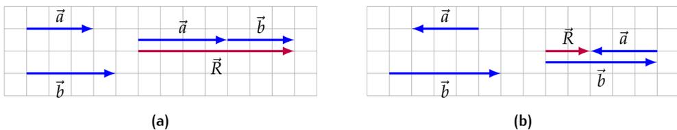
Figura 9: Somma di due vettori paralleli
