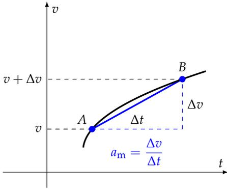
(a) L'accelerazione media è la pendenza della corda del diagramma velocità-tempo
