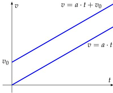
Figura 23: Diagramma velocità-tempo di due moti rettilinei uniformemente accelerati con uguale accelerazione
