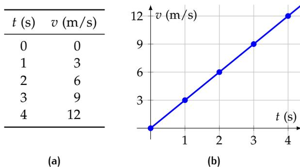
Figura 22: Velocità in funzione del tempo per un moto rettilineo uniformemente accelerato con  $a = 3 \text{ m/s}^2$
