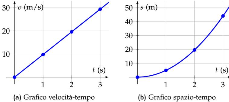
Figura 26: Rappresentazione grafica delle leggi di caduta di un grave nel vuoto
