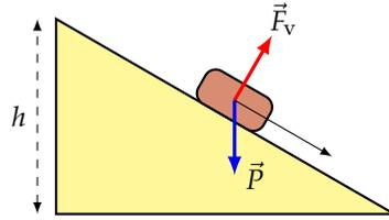
Figura 54: Moto di un corpo su un piano inclinato
