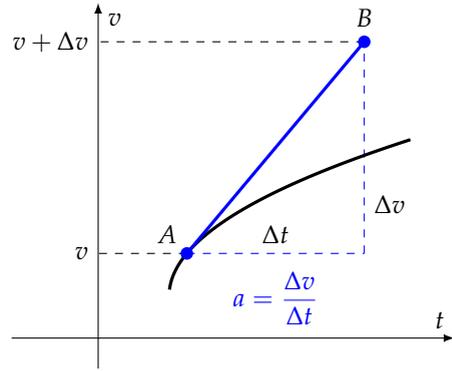
(b) L'accelerazione istantanea è la pendenza della tangente al diagramma velocità-tempo
