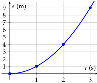
Figura 25: Diagramma orario di un moto uniformemente accelerato con  $a = 2 \text{ m/s}^2$
