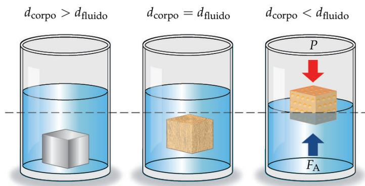
Figura 63: Principio di Archimede
