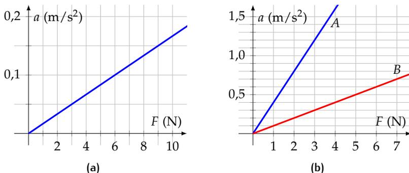
Figura 55: Diagrammi forza-accelerazione
