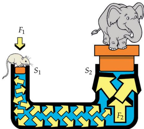
Figura 59: In un sollevatore idraulico, la forza trasmessa è tanto maggiore quanto maggiore è il rapporto tra le sezioni dei cilindri
