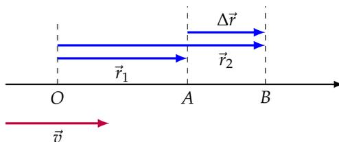
Figura 14: Velocità vettoriale nei moti rettilinei
