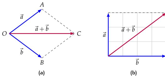
Figura 10: Regola del parallelogramma
