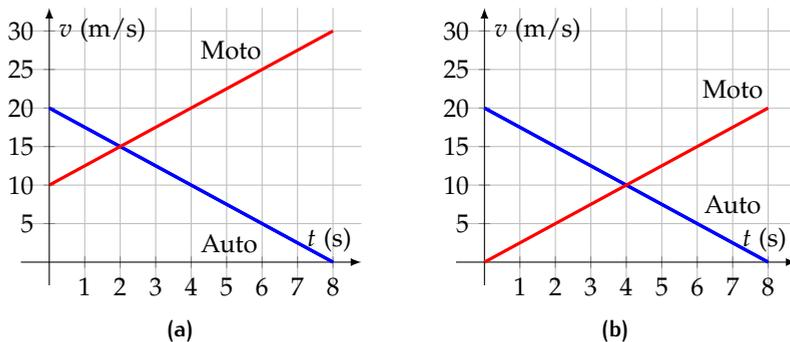
Figura 33: Diagrammi velocità-tempo di un'auto e una moto
